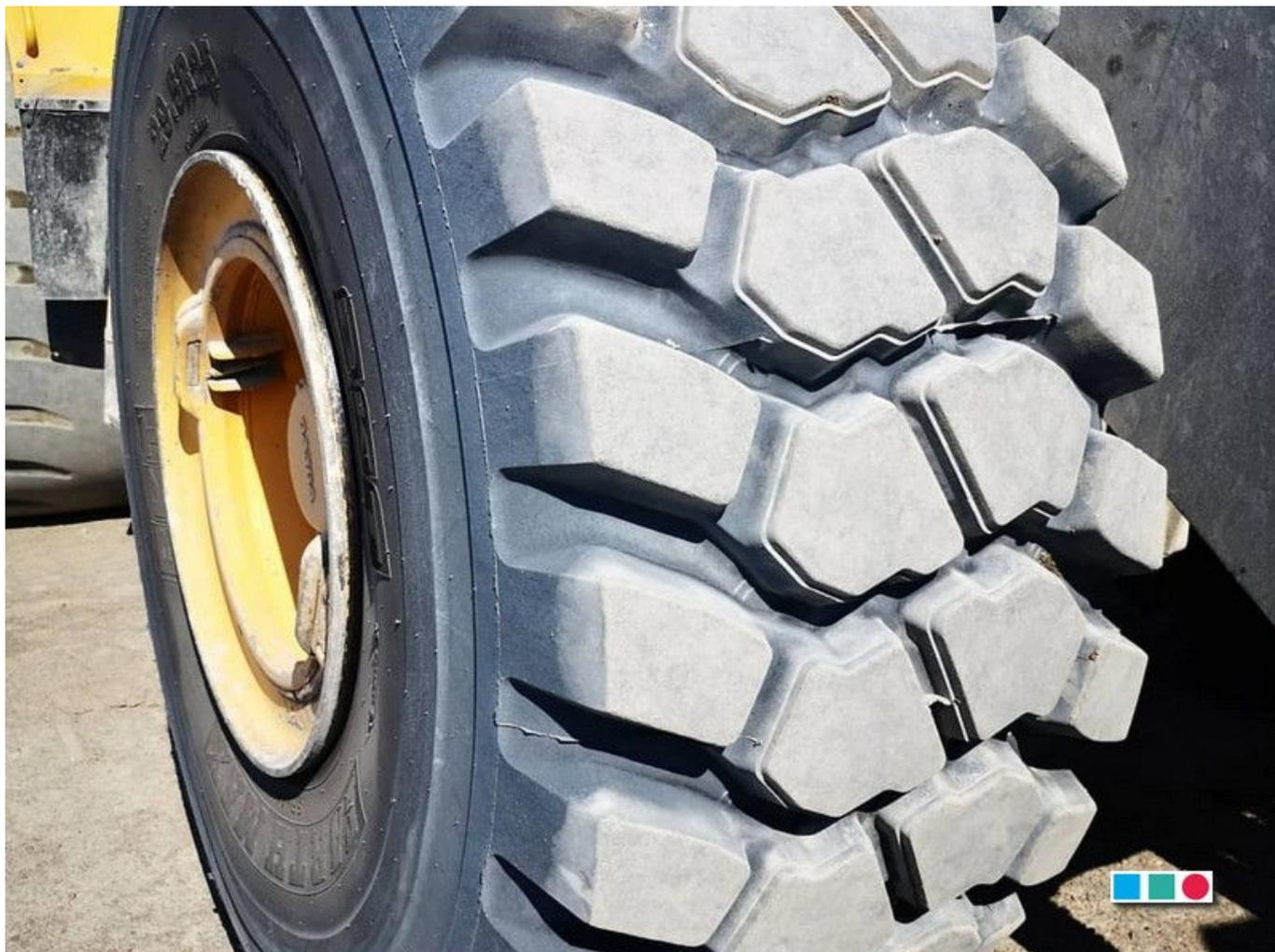
Глубокий рисунок протектора E-4/L-4 гарантирует долгий срок эксплуатации, а многослойный металлокордный брекер обеспечивает дополнительную прочность.
